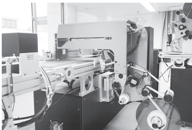
图 3-7 图书采分编智能作业系统（一期）RFID 标签的自动粘贴装置
