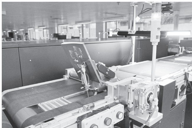
图 3-6 图书采分编智能作业系统（一期）图书姿态调整装置
